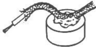
**Bild 4:** Koaxialkabel, dessen Geflecht auf 's Potigehäuse gelötet ist.
